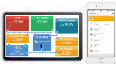
Visualisierung und Bedienung zusätzlich per Tablet, Portal und APP
