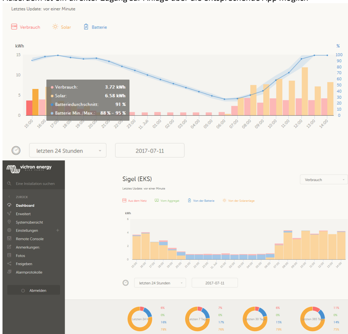
Beispiele einer ENERFLEX-Anlagenübersicht im Webportal
